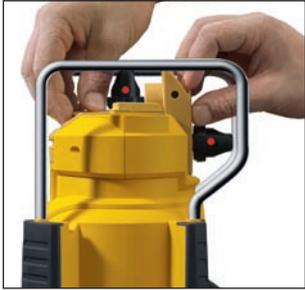
Wechsel von der Horizontal- in die Vertikalposition: Die komplette Prismeneinheit wird im Führungskanal um 90° präzise geschwenkt.
