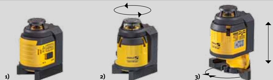
1) Parkstellung. 2) Gehäuse im U-Griff um 360° schwenkbar. 3) Durch den ausziehbaren Fuß ist der Laser höhenverstellbar. Die Anlagefläche ermöglicht das Positionieren des Lasers z. B. an U-Profilen.
