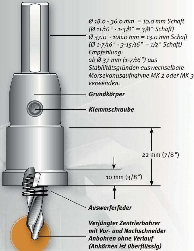
Diese hartmetallbestückte Lochsäge ist eine Mehrbereichs-Lochsäge für den universellen Einsatz bis zu einer Materialstärke von max. 10 mm (3/8") (ohne Auswerferfeder). Durch die stabile Konstruktion und eine weiterentwickelte Schneidengeometrie (Gebrauchsmuster 202 03 232 9) wird ein deutlich verbessertes Schneidverhalten erreicht, verbunden mit einer hohen Schneidleistung und Standzeit.
